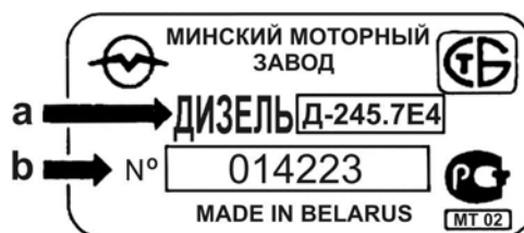
Рис. 1.2. Пример нанесение номера двигателя ММЗ Д-245.7 Е4
