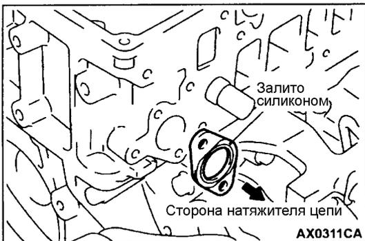
**►С◄ УСТАНОВКА ПРОКЛАДКИ НАТЯЖИТЕЛЯ ЦЕПИ ПРИВОДА ГРМ**
