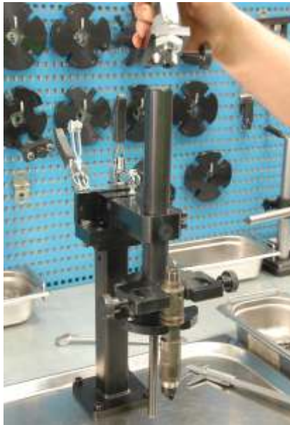
Снимите каретку осевого зажима с вертикальной стойки
