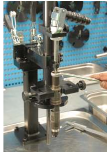
Зафиксируйте инжектор осевым зажимом и отверните гайку распылителя
