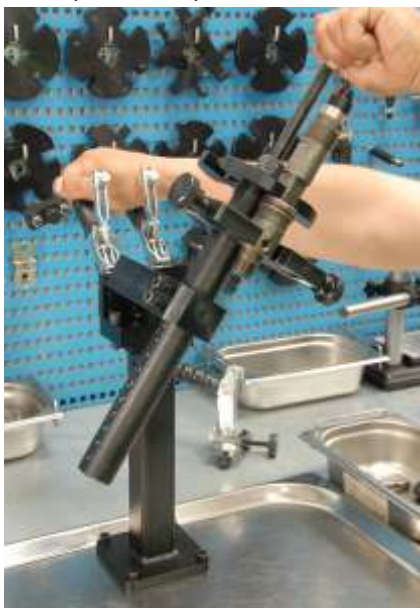
Разверните на 180° и зафиксируйте вертикальную стойку плитой-адаптером вверх
