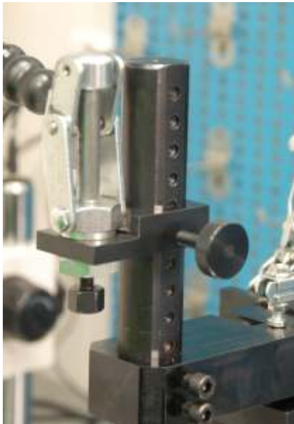
Запомните положение каретки осевого зажима относительно фиксирующих отверстий на вертикальной стойке
