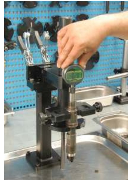
Установите на корпус инжектора адаптер с индикатором и измерьте ход иглы распылителя
