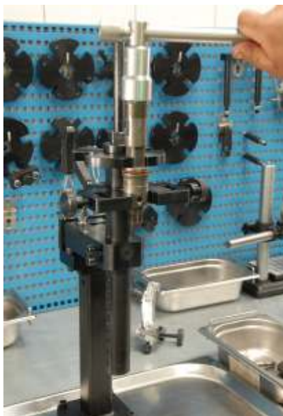
Отверните гайку и демонтируйте электромагнитный клапан
