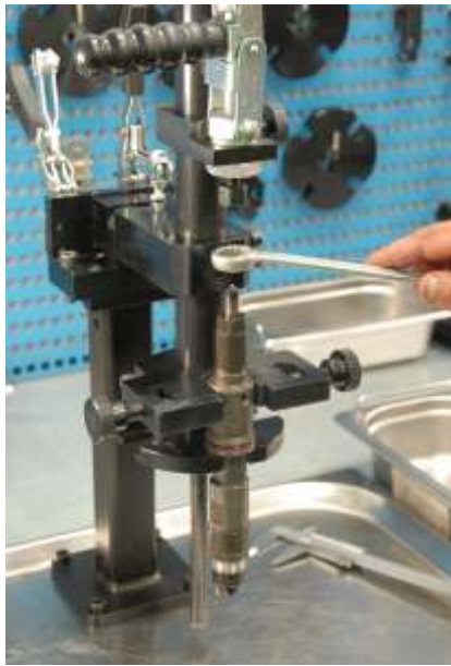
Поднимите осевой зажим и установите ключ на гайку распылителя
