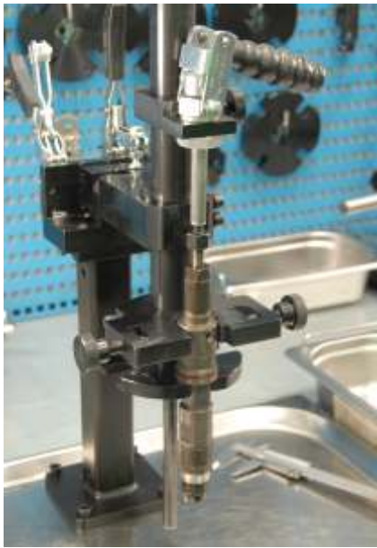
Инжектор надежно зафиксирован и готов к разборке и сборке
